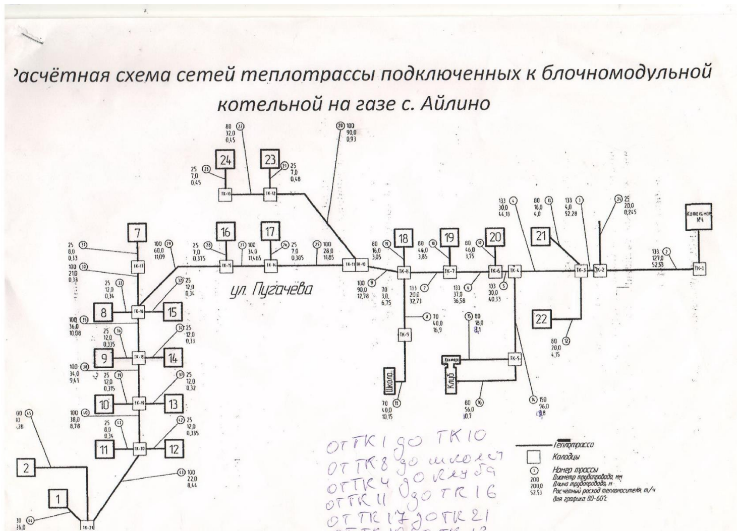
Рисунок 3.2.1 – Расчетная схема сетей теплотрассы подключенных к блочно-модульной котельной на газе с. Айлино
